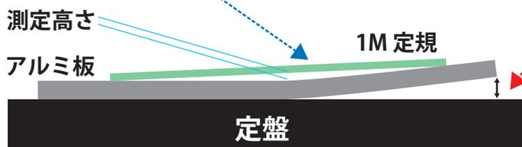
※ソリの測定は、定盤の上に切断品、4面フライス品を置き、自重で安定した状態にシクネスゲージを用いた保証値となります。
